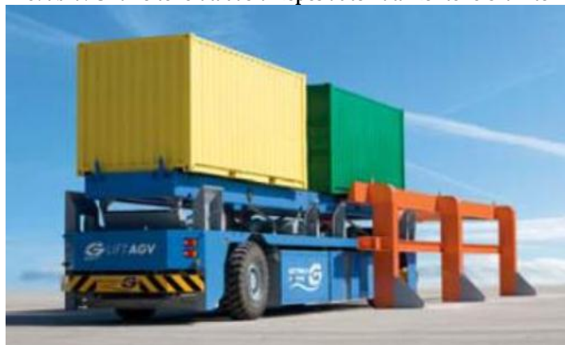
5. ábra: Önálló teherátadásra képes automata konténerszállító
